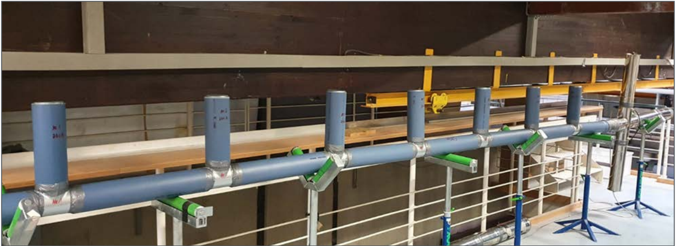
Abb. 12: Versuchsaufbau zur Validierung des periodischen Einheitszellenverbundes mit sieben \lambda/4 -Resonatoren
